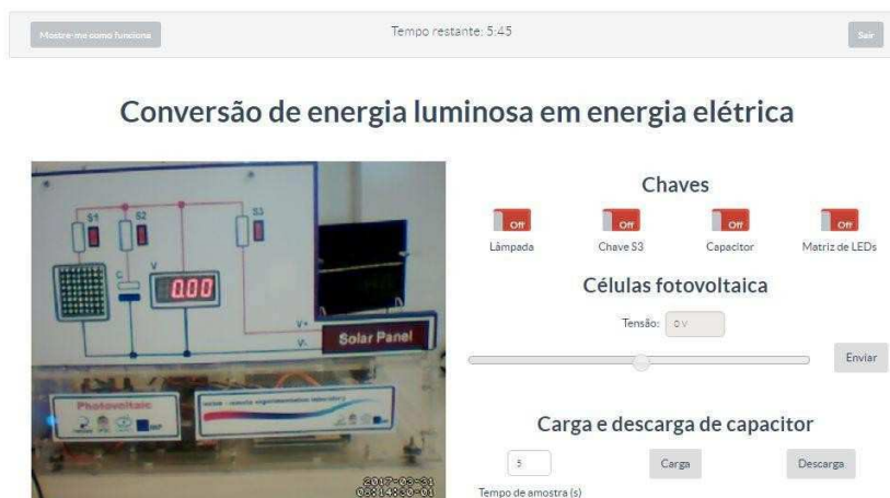
Figura 4: experimento remoto: conversão de energia luminosa em energia elétrica.
